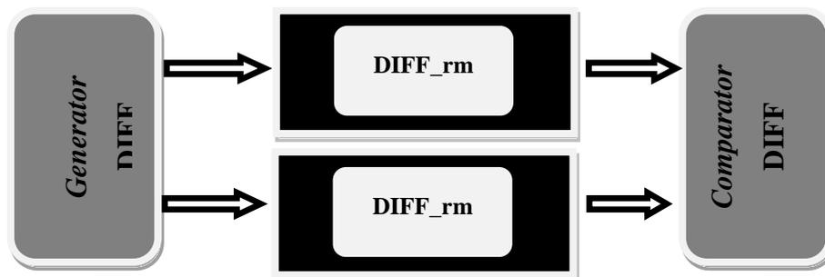
Figura 4.17: Estrutura do *Hierarchical Double Refmod* para o módulo DIFF
