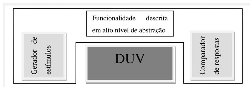
**Figura 2.2: Estrutura de um *testbench***
